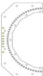
El número de LEDs está dividido por dos para las balizas que deben destellar sobre un rayo horizontal de 180° solamente. Esta opción permite disminuir el consumo de energía y el precio de la baliza.
